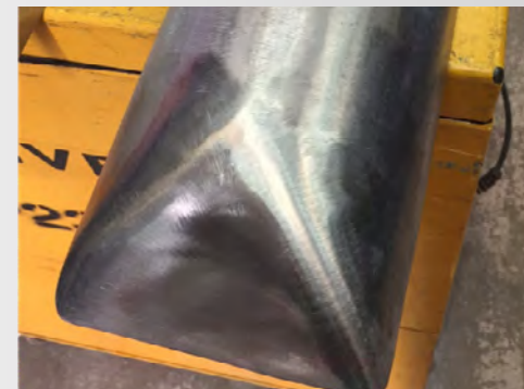
Gotowe – ślady po dysku fibrowym zostały usunięte, a cała powierzchnia została ujednolicona
