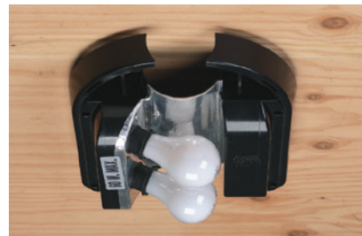
Dzięki dużej zdolności odbijania i przewodzenia ciepła taśma aluminiowa 3M chroni wrażliwe na ciepło komponenty umieszczone blisko źródeł światła w obudowie przycisku otwierania drzwi garażowych.
