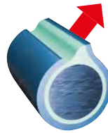
Naprężenia odrywające Siła odrywająca działa wtedy, gdy przynajmniej jeden łączony materiał jest elastyczny
