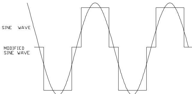
Zmodyfikowana krzywa sinusoidalna utworzona przez przetwornicę posiada napięcie RMS (root mean square – wartość skuteczna), które jest takie samo jak w gniazdce domowym. Większość woltomierzy AC (analogowych i cyfrowych) jest kalibrowanych dla napięcia RMS. Voltomierze nie odczytują napięcia RMS zmodyfikowanej krzywej sinusoidalnej dokładnie. Odczyt będzie około 20-30V niższy niż wartość faktyczna napięcia na wyjściu przetwornicy.
