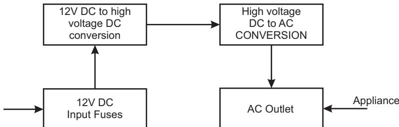
Pierwszy etap przetwarzania DC wykorzystuje nowoczesną technikę przetwarzania mocy wysokiej częstotliwości. W przetwornicy zastosowane są tranzystory MOSFET w pełnej konfiguracji mostkowej, które zapewniają doskonale możliwości przeciążeniowe i pozwalają przetwornicy pracować również na obciążeniach reaktancyjnych jak np. silniki indukcyjne.
